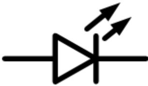
La LED est une diode électroluminescente : elle s'allume lorsqu'un courant passe dedans. Sa cathode (-) est plus courte que son anode (+). C'est un composant très pratique pour visualiser rapidement les états de certains circuits, car elle est facile à mettre en œuvre et consomme très peu de courant (en général 6 à 20 mA). Une LED se caractérise par sa tension de seuil qui exprime la tension à ses bornes lorsqu'elle est alimentée.
