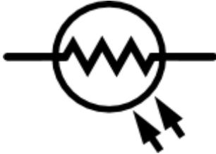
La cellule photoélectrique, ou photorésistance, est un semi-conducteur à résistance photo-variable. Elle permet de détecter et/ou mesurer la lumière.
