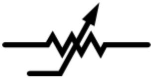
Le potentiomètre est en fait un composant à résistance variable, qui se règle avec un bouton ou une glissière. On change la résistance du potentiomètre par une manipulation physique ; c'est une interface humain/machine.
